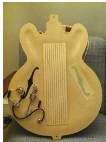
Une sorte de barrage longitudinal en épicea permet de solidariser la table et le bloc central.
