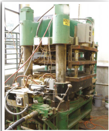
La presse qui donne forme aux tables des ES date des années 30 et est toujours en activité dans l'usine de Memphis.
