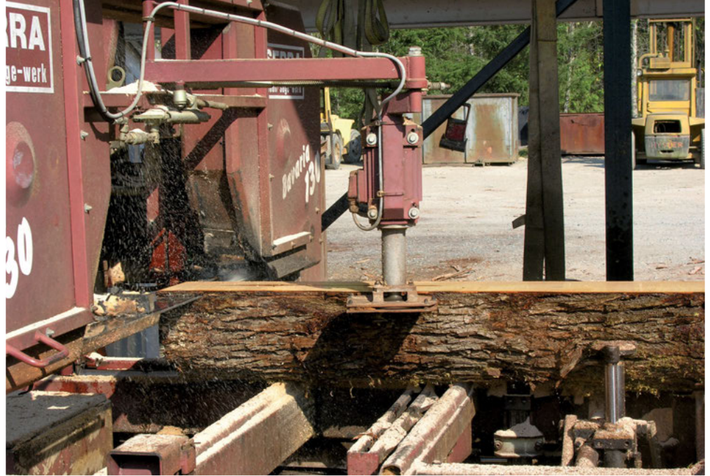
Les demi grumes sont débitées en planches d'environ 5 cm d'épaisseur.
