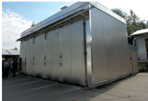
D'immenses cellules hermétiques permettent le séchage progressif des bois, sous une atmosphère ultra contrôlée.
