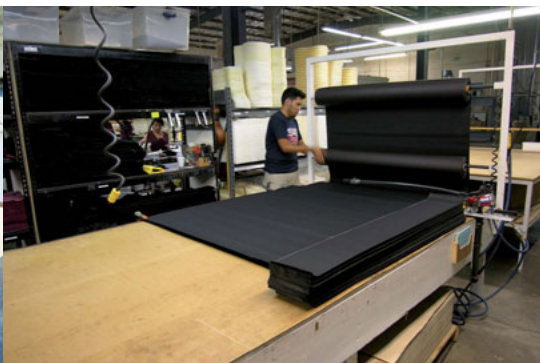
Pose du vinyle de protection externe. L'opération de marouflage est délicate, elle demande précision et doigté pour éviter le moindre pli ou bulle d'air.
