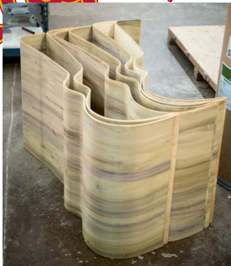
La demi structure de l'étui est sortie du moule. La réalisation prend forme...
