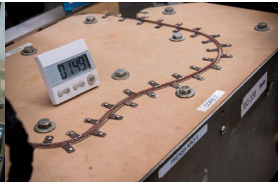
Mise en forme d'un étui, à partir d'un bois lamellé également fabriqué par Taylor. Remarquez le minuteur, pour un contrôle précis des durées de façonnage.
