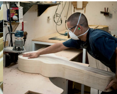
Le couvercle est directement découpé dans la structure de base, qui est alors fermée par deux capots, dont l'un constituera le fond, l'autre le couvercle monté sur charnières.
