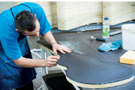
Pose du vinyle de protection externe. L'opération de marouflage est délicate, elle demande précision et doigté pour éviter le moindre pli ou bulle d'air.
