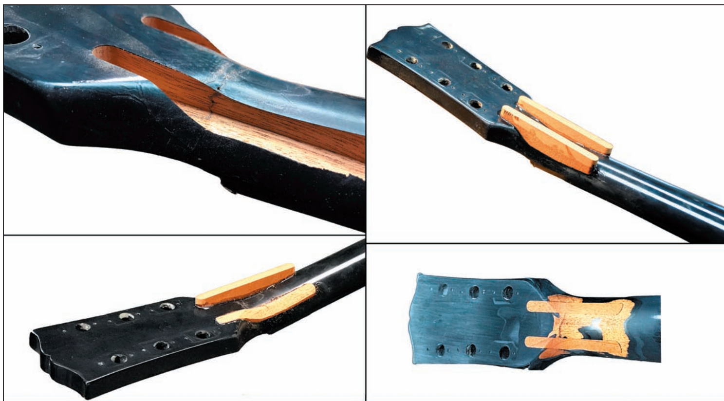
Réparation d'une tête SG Gibson cassée deux fois, la deuxième fracture étant réparée par Alexandre. Le manche est creusé à deux endroits et deux attelles y sont insérées et collées pour être ensuite rabotées.
