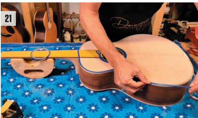
Après une nuit de séchage, je prépare ma table d'harmonie pour sa mise en teinte de façon à réchauffer la couleur naturelle assez pâle de l'épicéa. Pour ne pas que mes filets de caisse ainsi que ma rosace ne soient teintés, je les masque avec du scotch adapté.
