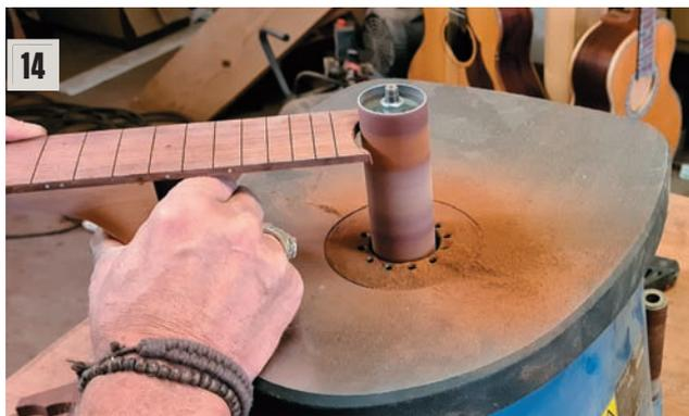
Je façonne ensuite à la ponceuse oscillante la fin de ma touche suivant le design recherché.
