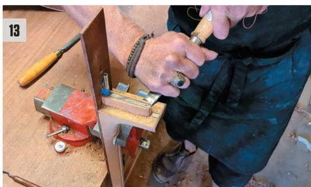
A la jonction corps/manche, la caisse étant légèrement arrondie, je creuse au ciseau à bois de chaque côté de mon tenon pour préparer la courbure nécessaire.
