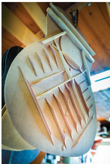
Contrefort de rosace en vue de pose des filets.
