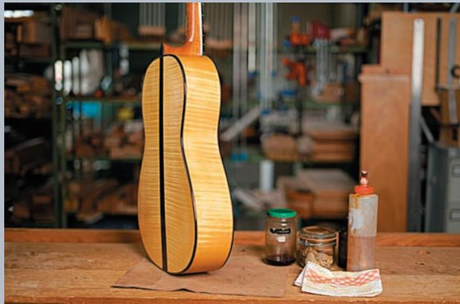
**20** On commence à obtenir un très beau poli sur toute la surface. La guitare étant vernie intégralement, on utilise un tampon encore plus sec avec une seule goutte d'alcool pur. Cela permet de polir la surface et enlever les restes d'huile. Une autre option serait d'utiliser une popote..
