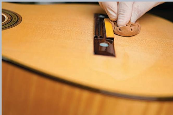
**19** Afin d'obtenir une couleur homogène, il est impératif que le parcours du tampon soit effectué de manière homogène sur toute la surface de l'instrument. Si l'on s'attarde davantage sur une zone, des taches plus foncées risquent de vite faire leur apparition...
