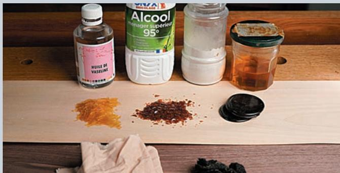
**3** A savoir : les copeaux de vernis mettent plusieurs jours à se dissoudre. C'est la raison pour laquelle il faut anticiper cette utilisation. En plus, il convient de prévoir un temps de décantage afin que la cire descende au fond du bocal. Une fois décanté, on prélève le vernis désiré à l'aide d'une seringue. Il est filtré de la même façon que le vernis blond, avec un simple filtre à café.
