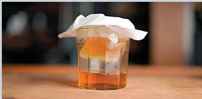
**4** Pour commencer, on passe une partie du tissu propre imbibé de la solution à la gomme-laque sur tous les filets afin de « fixer » les couleurs. Puis, vient l'étape de la première couche de vernis. Ces passages se font sans ajout d'huile, car cela permet entre autres de boucher les micropores de l'épicéa. Le mouvement effectué est circulaire ou en forme de huit.
