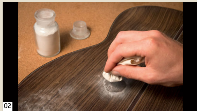
02 Avant d'appliquer le vernis, il faut préparer le bois en bouchant ses pores. Dans un premier temps, un sac rempli de ponce (une roche volcanique) est frappé sur l'ensemble de la surface à vernir – ici, le fond de la guitare.
