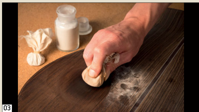
03 La friction d'un tampon rempli d'alcool sur la surface à traiter produit un mastic (un amalgame de ponce, de poussière de bois et d'alcool) qui pénètre dans chaque pore.
