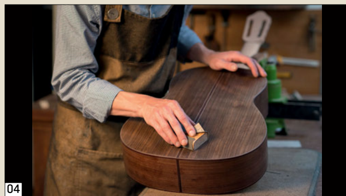
04 L'excédent de mastic en surface est poncé à l'aide de papier abrasif monté sur une cale.
