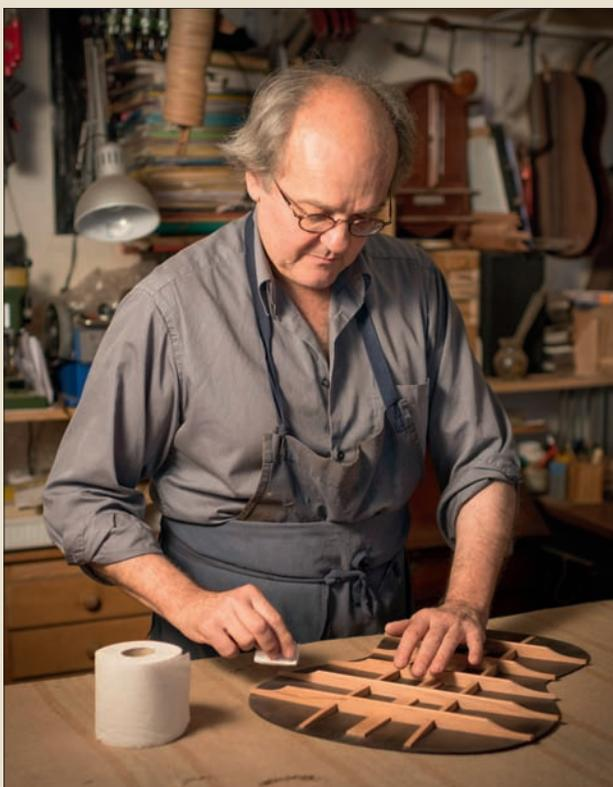
*Dominique Field nettoie ici, barre après barre, le fond d'une guitare avant assemblage définitif. Le fond est renforcé de cinq barres latérales et de deux barres longitudinales qui s'entrecroisent, assurant une rigidité optimale.*
