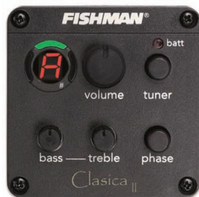
*Le préamplificateur Fishman propose une égalisation à deux bandes, un contrôleur de phase, un volume et un accordeur chromatique.*
