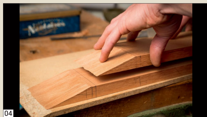
04 Les deux parties obtenues sont superposées afin de mettre parfaitement à plat la section coupée selon un angle de 14°, qui déterminera l'inclinaison de la tête par rapport au manche.
