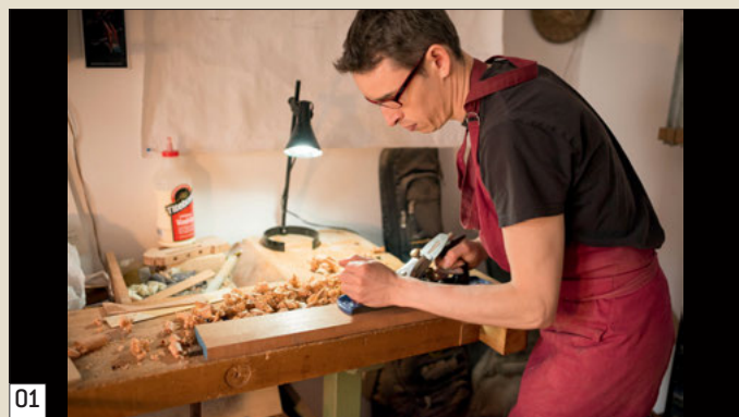
01 Une planche de cedro est mise à plat à l'aide d'un grand rabot (taille n° 5).
