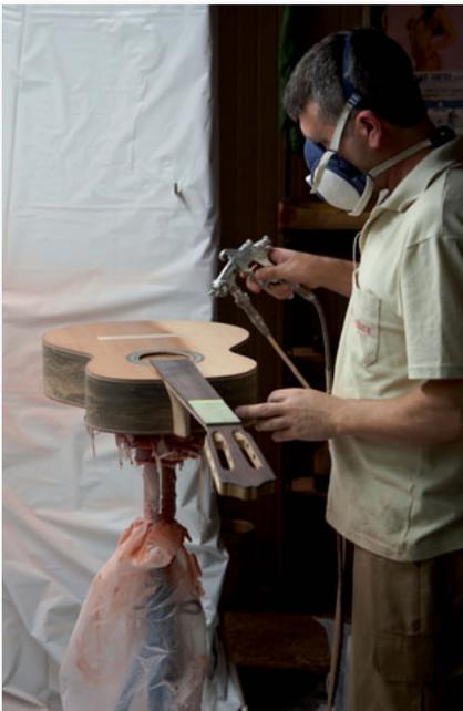
7. La pose du vernis polyuréthane garantit une protection optimum de l'instrument contre les petits chocs et rayures. Le passage au séchoir fixe le vernis avant les opérations de polissage, qui permettent de lui donner tout son éclat.
