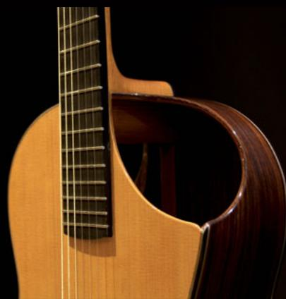
suffiraient pas. Sur le plan technique, la partie la plus délicate de ce nouvel instrument à réaliser concerne sans aucun doute les événements, sortes de pans coupés à la jonction de l'éclisse et de la table – et du fond pour la deuxième ouverture. La pose des filets, ici plus que périlleuse, est très bien réussie. L'ensemble est recouvert d'un vernis polyuréthane.
