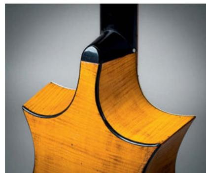
*Le fond et les éclisses sont d'un bel érable blond. Les filets d'ébène soulignent la forme particulière de la guitare; forme qui permet de « démancher » avec plus de commodité pour jouer les notes aigües.*
