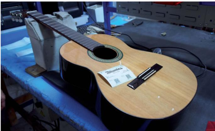
8. Avant la pose des cordes et mécaniques, les guitares sont inspectées avec minutie. Elles seront ensuite à nouveau jouées et auscultées avant de se voir apposer l'étiquette munie d'un code-barres, moyen infailible de tracer la guitare et d'en assurer un SAV efficace.
