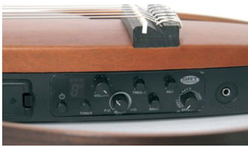
Le préampli est équipé d'un accordeur intégré, de deux bandes d'EQ, d'un volume, d'un mélangeur entre deux sonorités de capteur piézo et d'un sélecteur d'effets.
