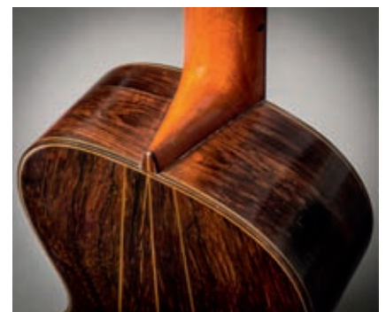
Pour ses modèles de style espagnol, Panormo utilise les bois employés en Espagne, le palissandre pour le fond et les éclisses, le cèdre pour le manche. On peut voir ici l'assemblage très soigné des différentes parties de palissandre de Rio, souligné de fins filets de bois clair.
