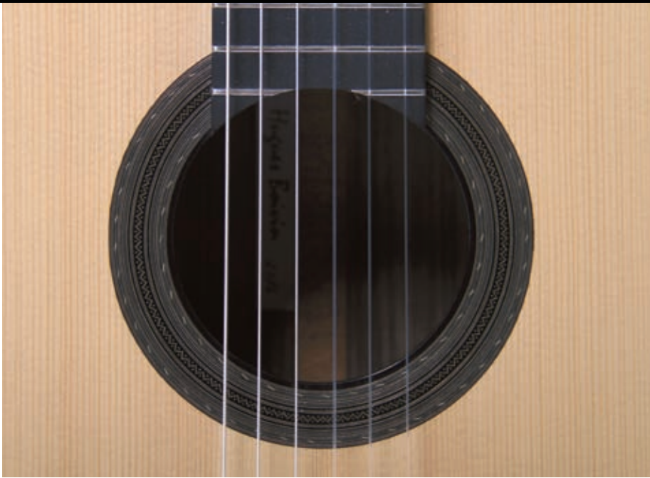
La rosace est réalisée en érable pour les parties blanches et en bois de poirier teinté pour les placages de couleurs noires et grises.
