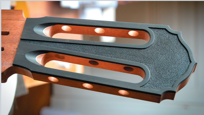
11 Les rampes pour le passage des cordes sont creusées.
