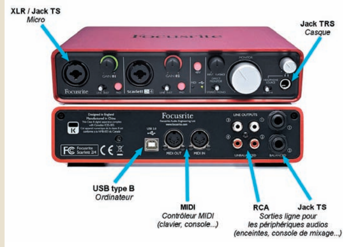
2 Connectique d'une interface audio numérique.
