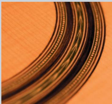
Torres assemblait ses rosaces directement sur la table, ce qui permet de les varier facilement d'une guitare à l'autre.
