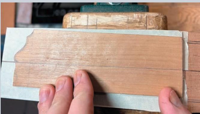
**4** La pièce de tête est placée sur le manche, la surface est dressée à l'aide d'un rabot. De cette manière, on peut facilement obtenir une parfaite surface de collage.
