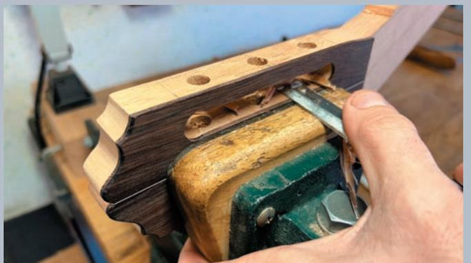
**18** Un bloc de bois est collé pour compléter la hauteur nécessaire de talon et de tasseau. J'utilise les taquets pour éviter tout glissement au moment du collage.
