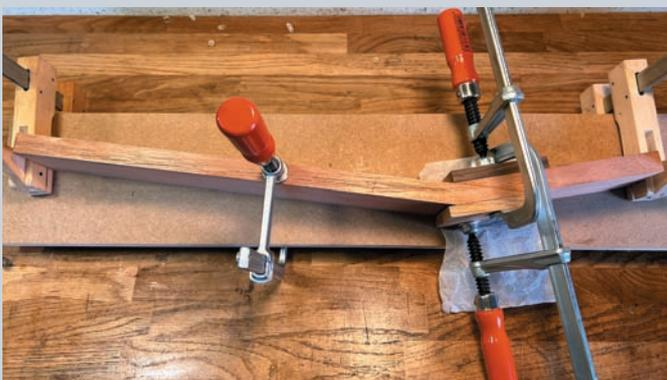
**7** Une coupe à 90 degrés aux deux surfaces de référence vient d'être faite. La photo représente là où le sillet de tête va s'appuyer.
