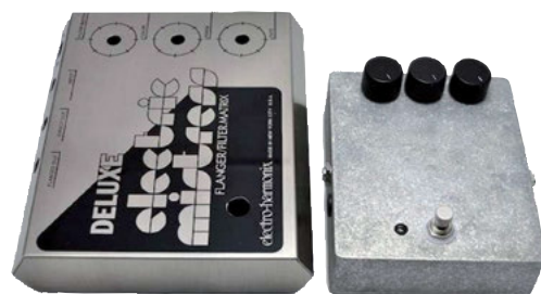
L'Electric Mistress d'Electro-Harmonix modifiée par FXDoctor. Plus petite, avec une amélioration du son grâce à des réglages affinés.
