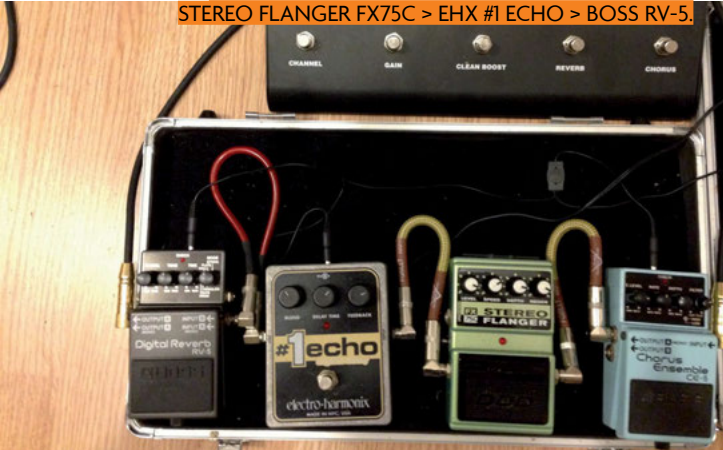
CHAINAGE DANS LA BOUCLE : BOSS CE-5 > DOD STEREO FLANGER FX75C > EHX #1 ECHO > BOSS RV-5.
