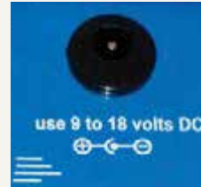
SUR CERTAINES PÉDALES , les différentes possibilités de voltage sont indiquées.
