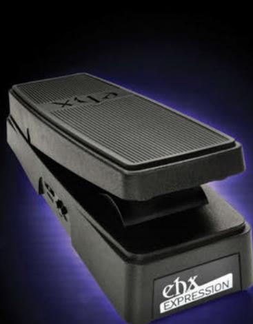
Contrôlez n'importe quel appareil avec une entrée pour pédale d'expression. Le potard de Range vous permet d'affiner la sensibilité de votre balayage. Le bouton Reverse inverse la course de fonctionnement de la pédale. Le switch de polarité et le câble TRS sont inclus. Abordable et polyvalente.
