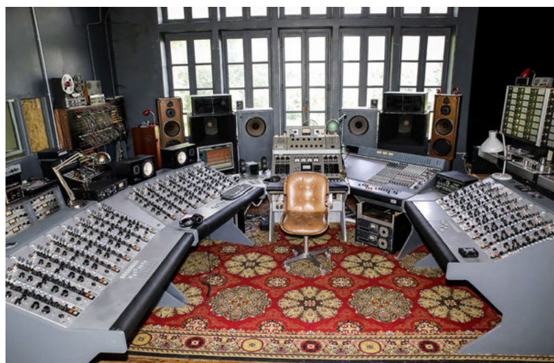
Pièce maîtresse de Kerwax, la console a été faite sur mesure avec une base empruntée à la table du mythique Studio des Dames et l'ajout de modules à lampes.
