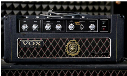
Vox Defiant, un des premiers amplis à transistors de la marque (entre 1969 et 1972).
