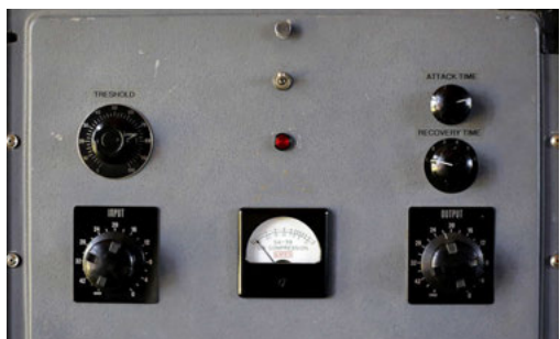
Varimu Compressor de la marque Gates, modèle SA-39, datant de la fin des années 30, utilisé à l'époque dans le broadcasting.
