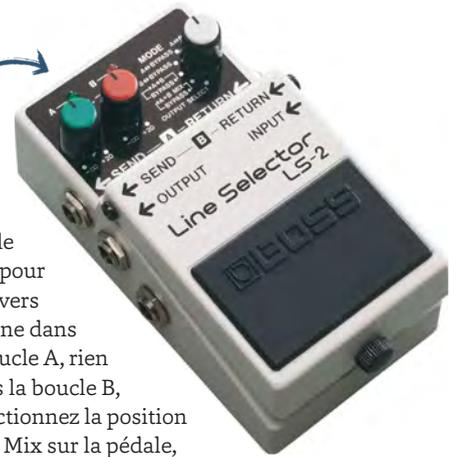
la boucle A, rien dans la boucle B, sélectionnez la position A+B Mix sur la pédale, et gérez les volumes de chaque boucle grâce aux potards Level A et Level B.
