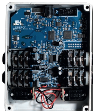
Une Electro-Harmonix Lester K Rotary Speaker : le CMS permet de développer des circuits complexes pour un encombrement raisonnable au format pédale.
