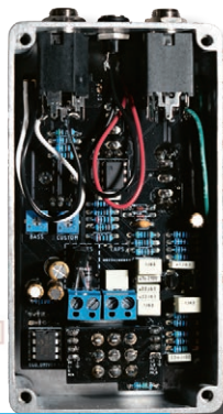
La Ego Driver d'Anasounds/FX Teacher est vendue en kit et on soude soi-même les composants traversants sur le circuit imprimé...
