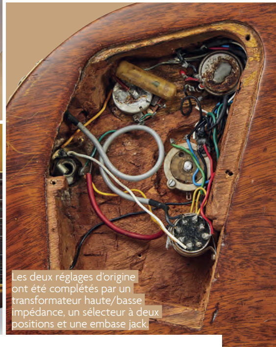
La cavité du sélecteur de micro a été agrandie pour accueillir une bobine transformant le micro manche en humbucker.
