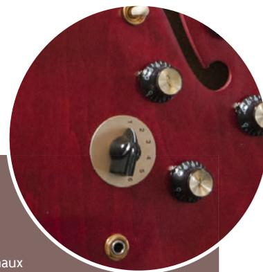
**D**esign de Walt Fuller, le Varitone est un « *notch filter* » : il agit par atténuation sur différentes fréquences (1875 Hz / 1090 Hz / 650 Hz / 350 Hz / 130 Hz), affectant le signal à la manière d'un EQ pré-paramétré. Surmonté d'un *chicken-head knob*, ce rotocontacteur à six positions offre ainsi des presets qui multiplient par autant les possibilités sonores de chacune des trois positions du sélecteur de micros. Mais son succès est tout relatif : il complexifie inutilement les réglages
