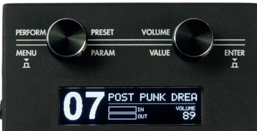
Deux potards-poussoirs pour naviguer dans les menus à l'écran
