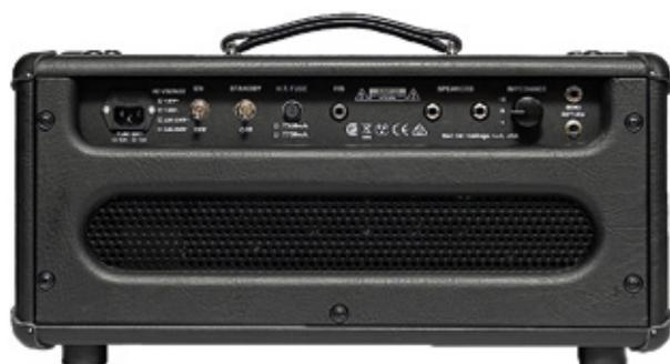
La face arrière avec sa boucle d'effets et le réglage d'impédance.
